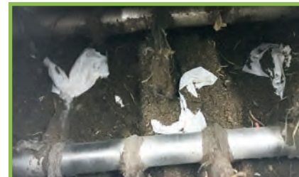
投入耗氧廚餘處理設備第 4 天 (被設備攪拌已經破碎成片)
